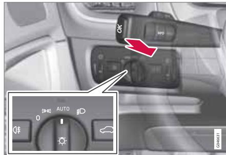
Ручка регулировки света и подрулевой рычаг.
