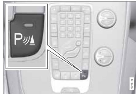
Переключатель датчиков системы помощи при парковке и CTA.
