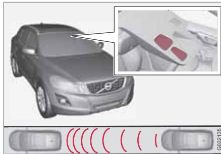
Приемно-выходное окно лазерного датчика<sup>1</sup>.
