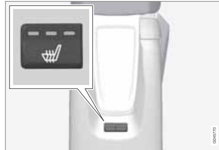
Одним нажатием на клавишу достигается максимальный обогрев – горят три лампы.
