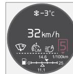
На приборной панели "Analogue" в центре комбинированного прибора показываются положения передач и находятся индикаторные стрелки.
