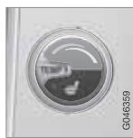
Максимальный обогрев включается, если на клавишу нажать один раз – три оранжевых штриха светятся на мониторе центральной консоли (см. рисунок выше).
