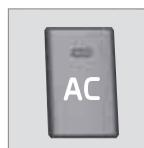
Когда в клавише **AC** горит лампа, кондиционирование воздуха работает в автоматическом режиме. В этом случае поступающий воздух при необходимости охлаждается и подсушивается.
