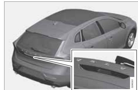
Обрезиненная пластина с электрическим контактом.
