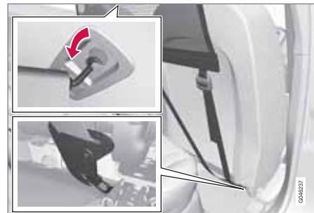
4. Закрепите анкерные стяжки сетки для крепления груза в проушинах сзади полозьев кресел – это легче сделать, если поднять спинки кресел и передвинуть кресла немного вперед.
