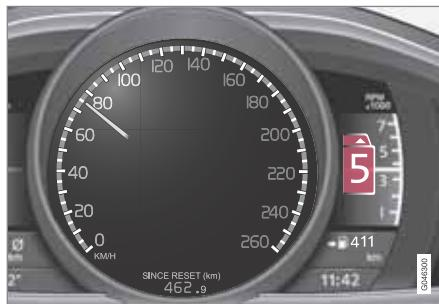
Приборная панель "Digital" с индикатором передачи.
