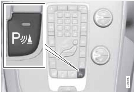
Выключатель (Вкл./Выкл.) для датчиков системы помощи при парковке и CTA (Cross Traffic Alert – Радар «заднего вида»), пред-
