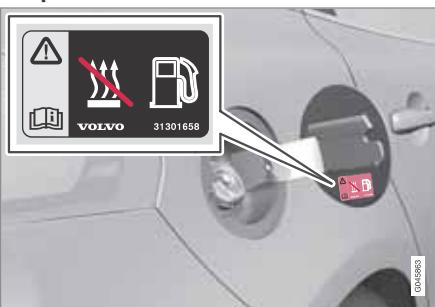
Предупреждающая табличка на крышки топливного бака.
