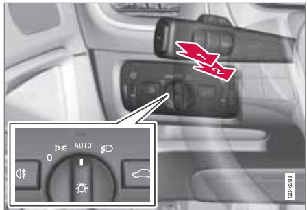
Ручка регулировки света и подрулевой рычаг.
