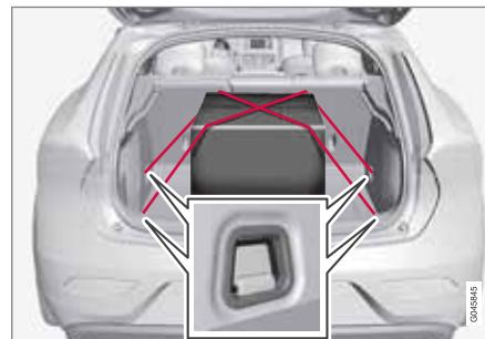
Проушины для крепления груза используются для фиксации стяжных лент, закрепляющих предметы в грузовом отделении.
