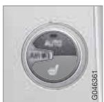
При помощи автофункции регулируется автоматически температура, кондиционирование воздуха, скорость вращения вентилятора, рециркуляция и распределение воздуха.
