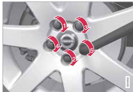
4. Затяните колесные болты крест-накрест. Важно, чтобы колесные болты были затянуты с нужной силой (момент затяжки - см. см. стр. 357). Проверьте момент затяжки динамометрическим ключом.
