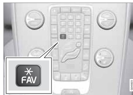
Кнопку **FAV** можно использовать для сохранения функций, которые вы часто используете, с тем, чтобы такая функция легко запускалась нажатием кнопки **FAV**. Для каждой функции вы можете выбрать
