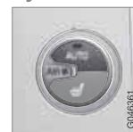
Для увеличения уменьшения скорости вентилятора поверните ручку, отсоедините **AUTO**. При выборе **AUTO** скорость вращения вентилятора регулируется автоматически – ранее установленные значения скорости вращения вентилятора отключаются.
