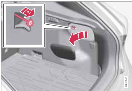
Крышка топливного бака открывается вручную, если невозможно открыть ее снаружи.
