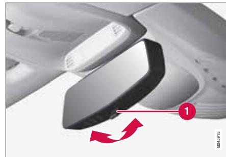
1 Установка противоослепляющего положения
