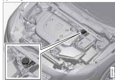
Расположение бачка с тормозной жидкостью.
