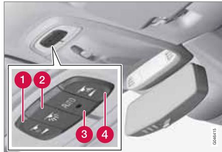
Клавиши управления в потолочной консоли передними лампами для чтения и освещением салона.
