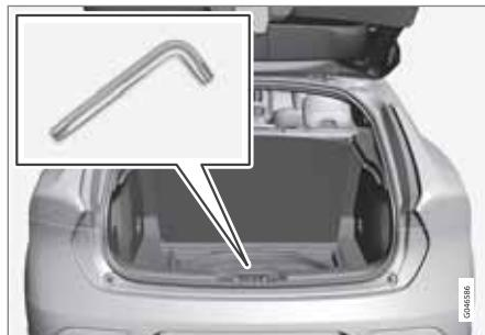
Возмите инструмент (Torx 30), который находится под люком в полу багажного отделения.
