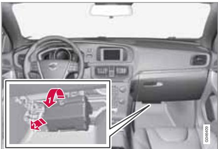
1. Захватите выемку и тяните, пока стопорные выступы в нижней части крышки на освободятся от распределительной коробки.
