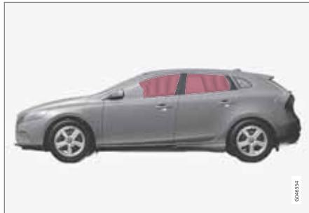
Надувной занавес IC (Inflatable Curtain) является частью системы SIPS. Он смонтирован в облицовке потолка вдоль боковин автомобиля и защищает пассажиров на внешних местах в автомобиле. При достаточно сильном столкновении датчики реагируют, и занавес надувается. Надувной занавес помогает во время столкновения защитить голову водителя и пассажиров от ударов о внутренние поверхности автомобиля.
