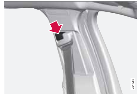
Regulacja wysokości pasa bezpieczeństwa. Nacisnąć przycisk i przesunąć pas w kierunku pionowym. Ustawić pas możliwie jak najwyżej, ale w taki sposób, by nie ocierał się o szyję.
