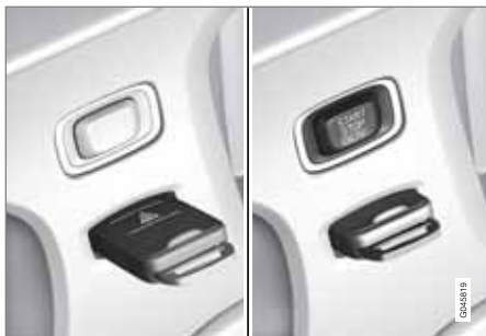
Wyłącznik zapłonu z wysuniętym/wsuniętym kluczykiem z pilotem zdalnego sterowania i przycisk START/STOP ENGINE .
