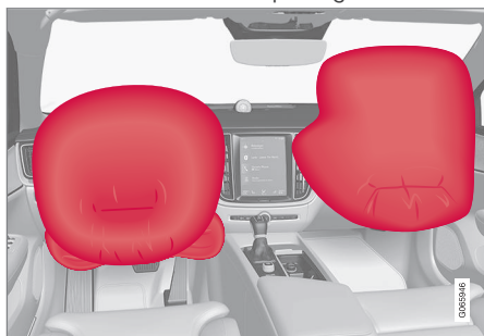
Coussins gonflables avant latéraux de conducteur/passager.
