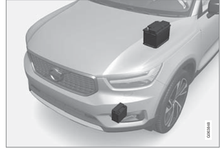
توجد البطارية المساعدة أسفل حجيرة المحرك، كما تُعرض بطارية البادئ هنا (بالأعلى).
