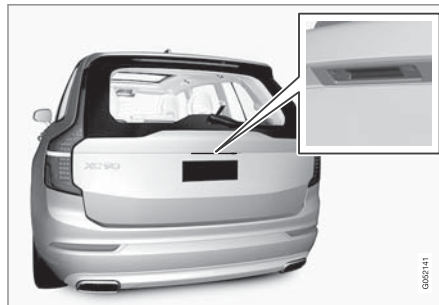
テールゲートのラバー加工されたプレッシャープレート(ロック解除のみに使用)
