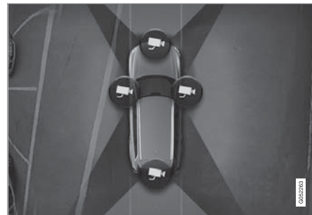
パークアシスト・カメラの位置および動作範囲
