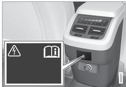
トンネルコンソールの 230V 電源ソケット (2 列目シート)
