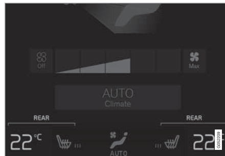
クライメートビューの リア・エアコン タブの温度ボタン
