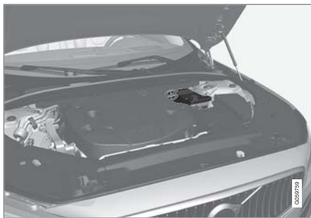
支援電瓶位於支撐桿旁的電瓶箱中。
