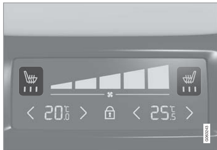
前座中央扶手後方恆溫控制面板上的座椅加熱指示與控制裝置。
