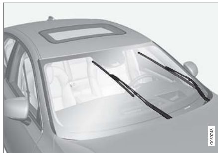
位於維修位置的雨刷片。
