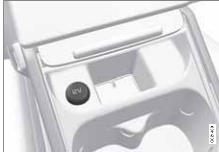
12 V-uttag i tunnelkonsol, framsäte.
