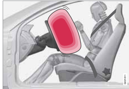
Placering av krockkudde på passagerarsidan i vänsterstyrd bil.
