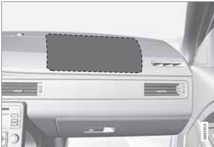
Placering av krockkudde på passagerarsidan i vänsterstyrd bil.
