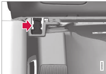
Toma para diagnósticos (toma On-board Diagnostic, OBDII) bajo el tablero de instrumentos en el lado del conductor.
