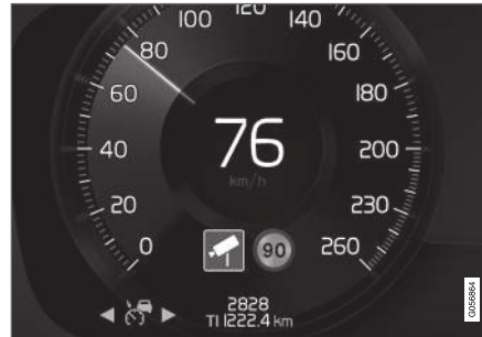
Información sobre cámaras de control de velocidad en la pantalla del conductor 106 .
