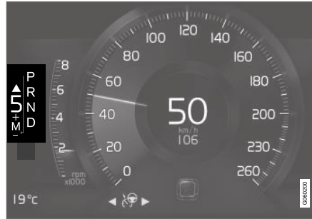
Indicateur de rapport sur l'écran conducteur 8 pouces.
