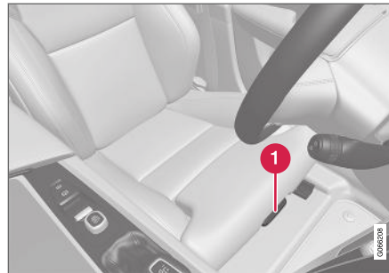
Commande de réglage de coussin.
