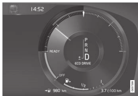
Compteur ECO sur l'écran conducteur 12 pouces*.
