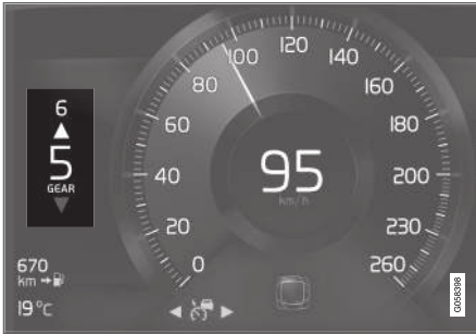
Indicateur de rapport sur l'écran conducteur 8 pouces.
