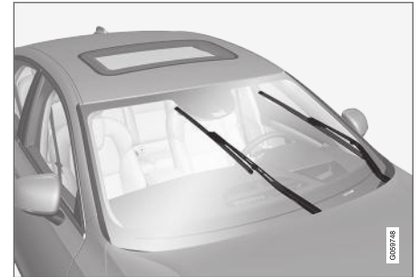
Balais d'essuie-glace en position d'entretien.
