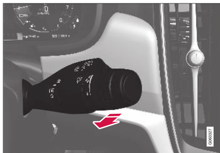
Fonction lave-glace, levier droit au volant
