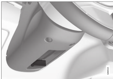
Levier de réglage du volant.
