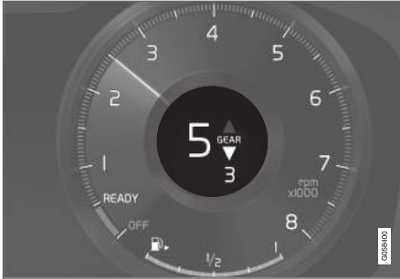
Indicateur de rapport sur l'écran conducteur 12 pouces*.
