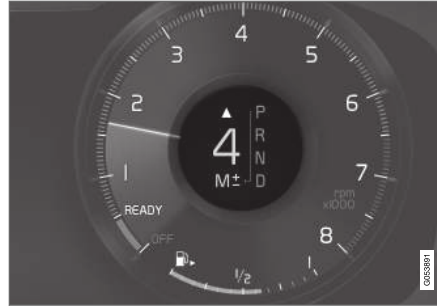
Indicateur de rapport sur l'écran conducteur 12 pouces*.
