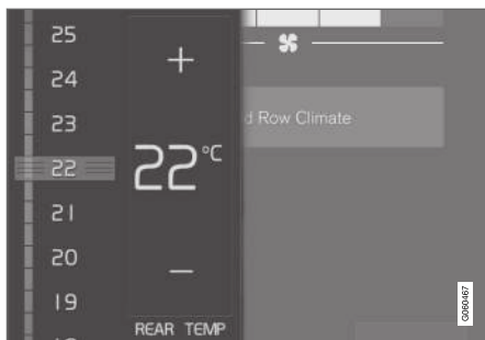
Commande de température.
