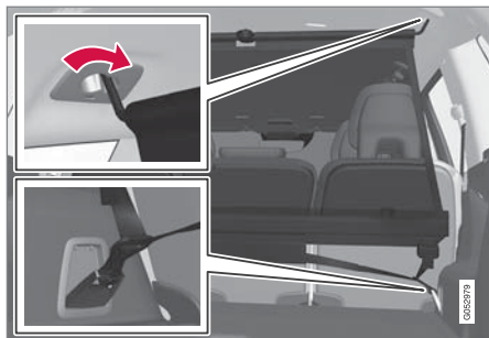
後段安裝位置。
