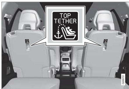
六人座車款：固定點位置如椅背後方符號所指示處。 固定點位於第二排外側座椅。
