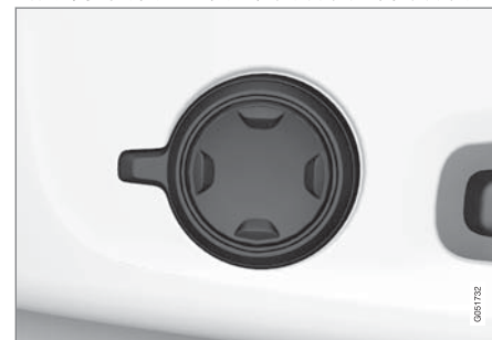
多功能控制器，位於座椅的座部側面。
