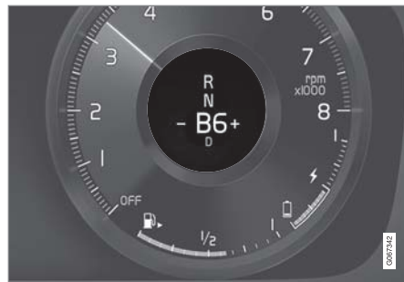
駕駛人顯示器中的換檔指示器 5 。
