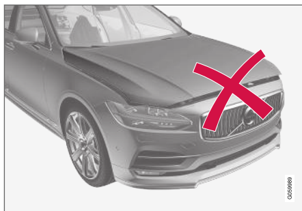
Niedomknięta pokrywa silnika.
