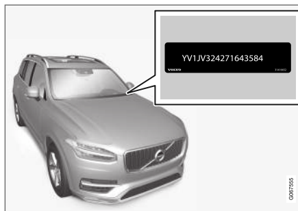
Numer VIN jest umieszczony w podobnym miejscu we wszystkich modelach.
