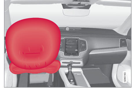
الوسادة الهوائية في عجلة القيادة والوسادة الهوائية عند الركبة في جانب السائق في المقعد الأمامي.
