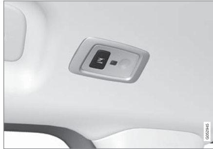
في السيارات المزودة بسقف بانوراما* توجد وحدات مصابيح واحدة في كل جهة من جهتي السقف ٧ .
