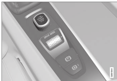
Pokrętle rozruchu na konsoli między fotelami.
