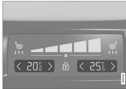
Hőmérséklet-vezérlés az alagútvezető hátsó klímapaneljén.
