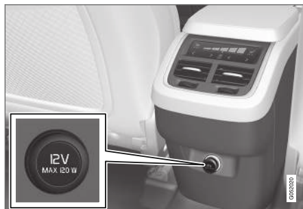
Prise électrique 12 V sur la console de tunnel, deuxième rangée de sièges.
