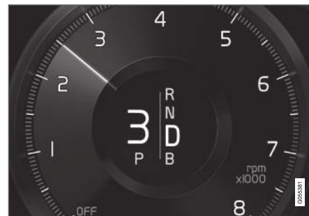
Écran conducteur lors d'un changement de rapport avec les palettes du volant.
