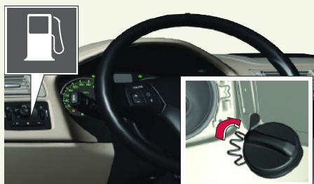
**Нажмите клавишу , чтобы открыть крышку топливного бака. Во время заправки подвесьте пробку заливной горловины.**
