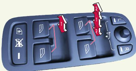
**L R** **Установка внешнего зеркала,** выберите **L** или **R**. Установите с помощью ручки.
