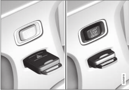
Uzaktan kumanda anahtarlı kontak anahtarı çıkartıldı/takıldı.
