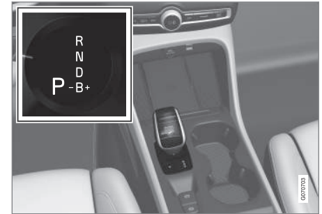
Vue d'ensemble du levier de rapport avec grille de passage des rapports à l'écran conducteur
