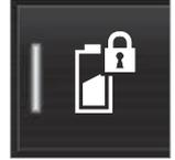
تحتفظ الوظيفة على شحن البطارية الهجينة لتشغيل المحرك الكهربائي وتوفير الكهرباء المتاحة لاستخدامها لاحقاً، أي للقيادة في بيئة حضرية أو في منطقة
