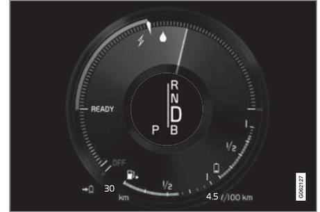
يتعذر على المحرك الكهربائي توفير المقدار المطلوب من طاقة المحرك ومن ثم يبدأ عمل محرك الاحتراق الداخلي.
