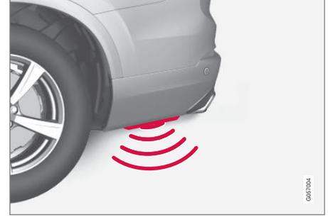
لتنشيط الفتح أو الإغلاق بحركة من القدم في السيارة المزودة بلوح انزلاق، ينبغي القيام بحركة الركل من جانب السيارة. يجب أن يكون أحد مفاتيح التحكم عن بعد في السيارة داخل نطاق السيارة (متر واحد تقريباً (٣ أقدام)) حتى يكون الفتح والإغلاق ممكنًا.
