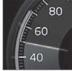
السرعة الأعلى هي المحفوظة/المضبوطة والسرعة الأدنى هي سرعة السيارة التي أمامك (السيارة الهدف).
