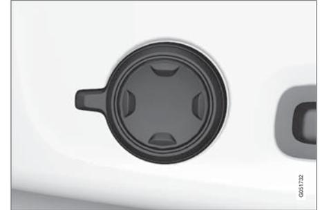
أدوات التحكم المتعددة الوظائف في السيارات المجهزة بدعامة أسفل الظهر الرباعية الاتجاه\*.
