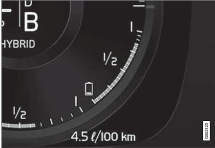
يتم استخدام الطاقة في البطارية الهجينة لتشغيل المحرك الكهربائي ولكن كذلك لتبريد السيارة أو تدفئتها. يتيح حاسوب الرحلة حساب المسافة التقريبية التي يمكن قطعها بالطاقة المتبقية في البطارية الهجينة.
