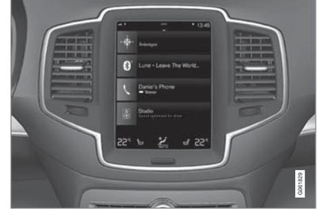
يتم التحكم في الكثير من الوظائف الأساسية للسيارة من الشاشة المركزية، شاشة لمس تتفاعل مع اللمسات. وبالتالي يقل عدد الأزرار الحقيقية وأزرار التحكم في السيارة. ويمكن تشغيل الشاشة حتى أثناء ارتداء القفازات.
