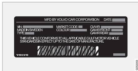
1 ملصق المصادقة. تصميم النوع ورقم تعريف السيارة والحد الأقصى للأوزان المسموح بها ورموز الألوان ورقم نوع
