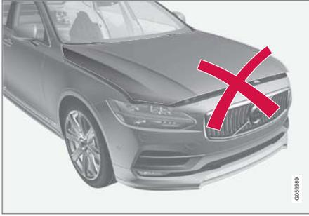
لم يتم إغلاق غطاء المحرك بالكامل. الصورة تمثل رسماً توضيحياً - وقد تختلف الحقيقة عن الصورة باختلاف طراز السيارة.
