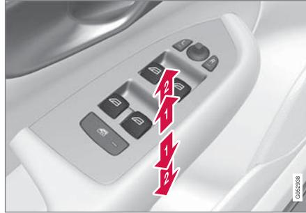
تشغيل النوافذ الكهربائية.
