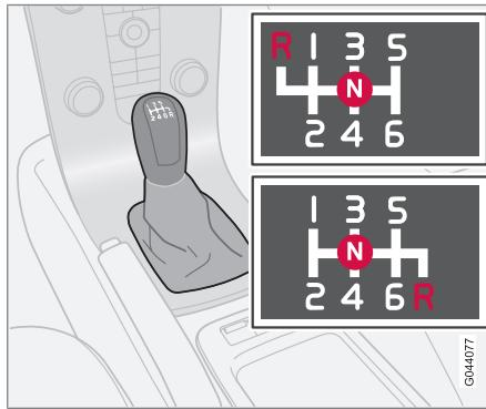
Схема переключения передач, 6-ступенчатая коробка передач
