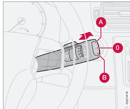
При перемещении рычага вперед запускается омывание и очистка заднего стекла. После завершения омывания щетка стеклоочистителя совершает несколько дополнительных ходов. Кнопка в торце рычага является трехпозиционным переключателем:
