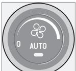
В режиме **AUTO** система управления микроклиматом автоматически поддерживает заданную температуру. Автоматическая функция управляет отоплением, кондиционированием воздуха, скоростью вентилятора, рециркуляцией и распределением воздуха.
