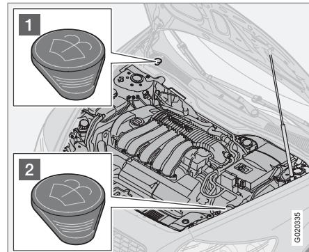
Местоположение бачка омывающей жидкости<sup>4</sup>.
