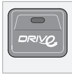
В некоторых ситуациях, если необходимо временно отключить автоматическую функцию Start/Stop, следует нажать на эту кнопку, при этом лампа в кнопке гаснет.
