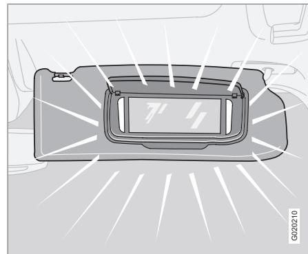
Лампа включается или выключается автоматически, когда крышка соответственно открывается или закрывается.
