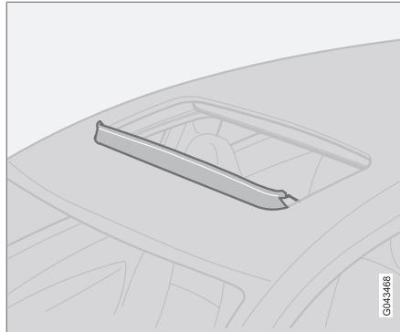
В люке крыши имеется воздухоотражатель, который откидывается, когда люк открыт.
