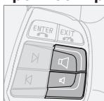
Громкость разговора регулируется при помощи кнопок на рулевом колесе.
