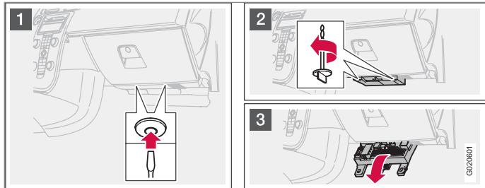
В блоке находятся 50 гнезд предохранителей. Предохранители находятся под отделением для перчаток. Там же предусмотрены гнезда для резервных предохранителей. Инструмент для замены предохранителей находится в блоке реле/предохранителей в двигательном отсеке, см. стр. 273.
