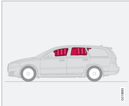
Надувной занавес IC (Inflatable Curtain) является составной частью SIPS и подушек безопасности. Он смонтирован в облицовке потолка вдоль боковин автомобиля и защищает пассажиров на внешних местах в автомобиле. При достаточно сильном столкновении датчики реагируют, и занавес надувается. Надувной занавес помогает во время столкновения защитить голову водителя и пассажиров от ударов о внутренние поверхности автомобиля.
