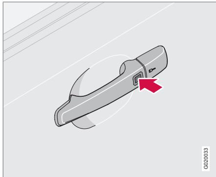
*В автомобилях с системой Keyless во внешних дверных ручках имеется кнопка.*
