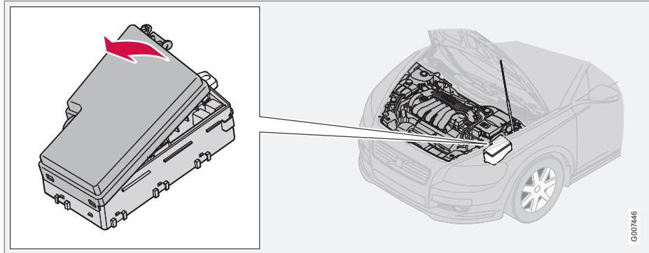
В блоке находятся 36 гнезд предохранителей. При замене перегоревшего предохранителя убедитесь, что новый предохранитель имеет такие же цвет и ампераж.
