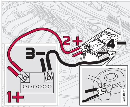
Если аккумуляторная батарея разряжена, автомобиль можно запустить током от другой аккумуляторной батареи.
