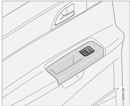
Управление стеклами задних дверей возможно клавишами соответствующих дверей или переключателем с двери водителя.
