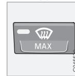
Для быстрого удаления запотевания и обледенения с переднего и боковых стекол. Поток воздуха направляется к стеклам на высокой скорости вентилятора. Лампа в кнопке дефростера горит при включенной функции.
