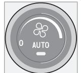
Для увеличения уменьшения скорости вентилятора поверните ручку. Если выбирается **AUTO**, скорость вентилятора устанавливается автоматически.
