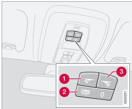
Клавиши управления в потолочной консоли передними лампами для чтения и освещением салона.
