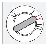
Положение дистанционного ключа во время движения. Вся система электрооборудования подключена.
