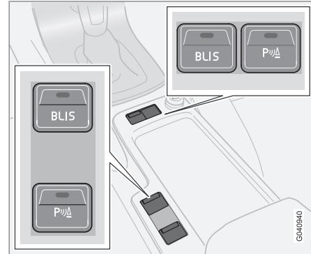
*Кнопка Выкл/Вкл (расположение кнопки зависит от выбранного оборудования).*
