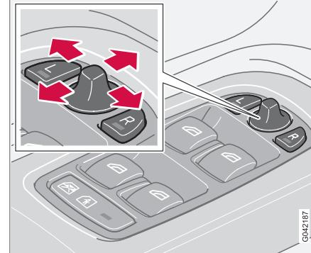
Переключатели установки двух наружных зеркал находятся на передней части подлокотника на двери водителя. Зеркала заднего вида можно устанавливать, когда ключ находится в положении I и II.
