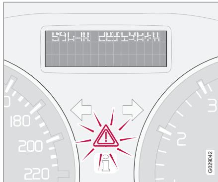
Если автомобиль участвовал в столкновении, на информационном дисплее может появиться текст **АВАРИЙН. РЕЖИМ СМ. РУКОВОДСТВО**. Это означает, что не все функции автомобиля выполняются в полном объеме. Аварийный режим – это защита, которая задействуется, когда во время столкновения могли быть повреждены важные функции автомобиля, например, топливопроводы, датчики одной из систем защиты или система тормозов.
