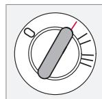
Блокировка рулевого колеса отключена. Некоторыми функциями можно пользоваться. Электросистема двигателя не подключена.
