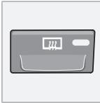
Обогрев используется для удаления обледенения и запотевания с заднего стекла и зеркал заднего вида. Если нажать один раз на кнопку, одновременно начинается обогрев заднего стекла и зеркал заднего вида. Если в кнопке горит лампа – функция активирована.
