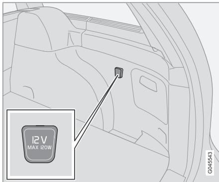
Чтобы получить доступ к электрическому гнезду, откините крышку. Питание на гнездо подается независимо от того, включено зажигание или нет.
