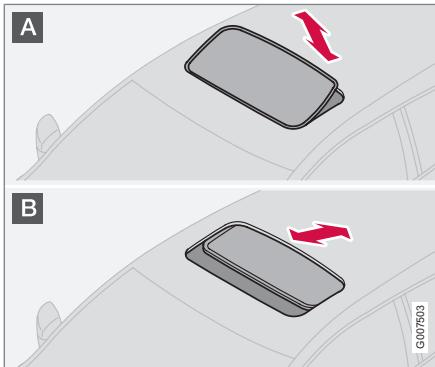
Органы управления люком в крыше расположены на потолке. Люк можно открыть в два положения:
