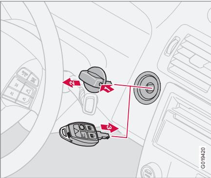
Если сигнализация не отключается дистанционным ключом, например, разряжены батарейки в ключе, автомобиль можно отпирать, снять с сигнализации и запустить двигатель следующим образом:
