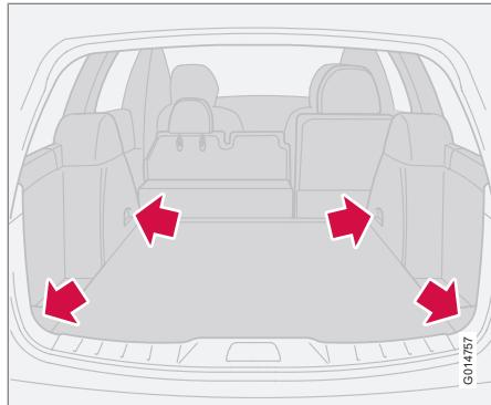
Крепежные проушины служат для крепления багажных ремней или сеток, предназначенных для фиксации груза в грузовом отсеке.
