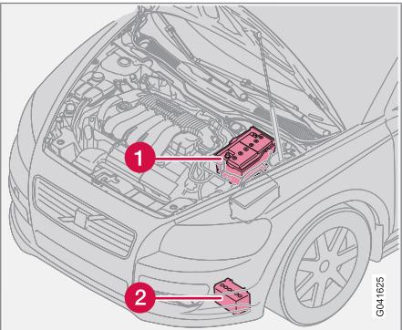
1. Пусковой аккумулятор<sup>2</sup> 2. Вспомогательный аккумулятор
