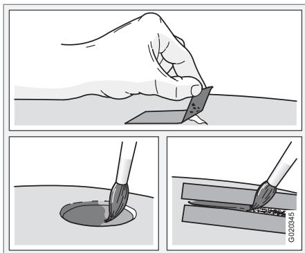
Перед началом работ по восстановлению лакокрасочного покрытия автомобиль необходимо вымыть и высушить, а его температура не должна превышать 15 °C.
