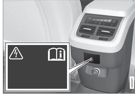
مقبس كهربائي بقوة ٢٣٠ فولت في كونسول النفق، في مقعد الصف الثاني.
