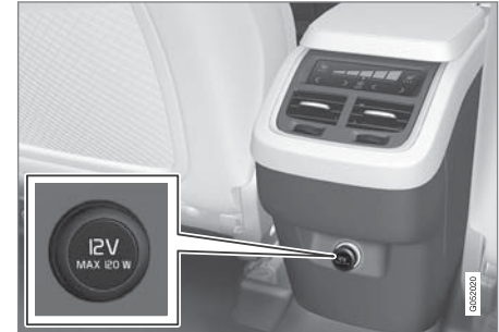
مقبس كهربائي بقوة ١٢ فولت في كونسول النفق، مقعد الصف الثاني.
