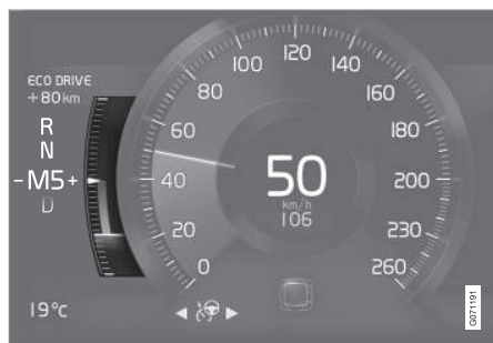
Indikace Eco na 8" displeji řidiče.
