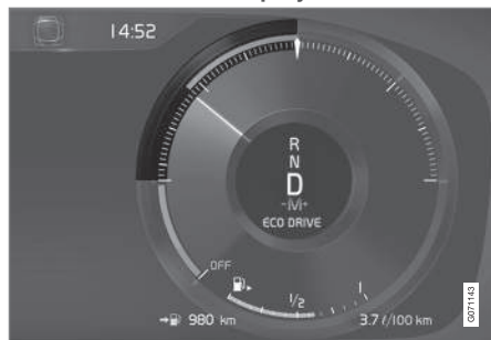
Indikace Eco na 12" displeji řidiče*.
