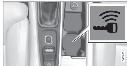
Umístění záložní čtečky v tunelové konzole.
