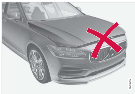
引擎蓋並未完全關閉。
