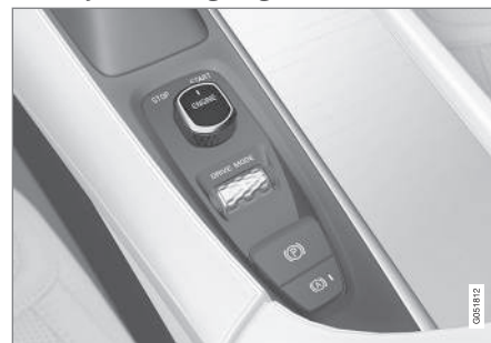
Startvredet i tunnelkonsolen.
