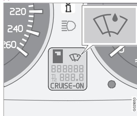
Датчик дождя контролирует количество воды на ветровом стекле и автоматически активирует стеклоочистители. Чувствительность датчика дождя можно регулировать с помощью регулировочного кольца (C), см. стр. 71.
