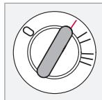
Блокировка рулевого колеса отключена. Некоторыми функциями можно пользоваться. Электросистема двигателя не подключена.
