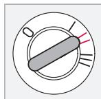
Положение дистанционного ключа во время движения. Вся система электрооборудования подключена.
