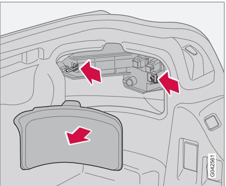
Все лампы накаливания в задней комбинации заменяются изнутри багажного отделения.
