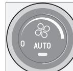
В режиме **AUTO** система управления микроклиматом автоматически поддерживает заданную температуру. Автоматическая функция управляет отоплением, кондиционированием воздуха, скоростью вентилятора, рециркуляцией и распределением воздуха.
