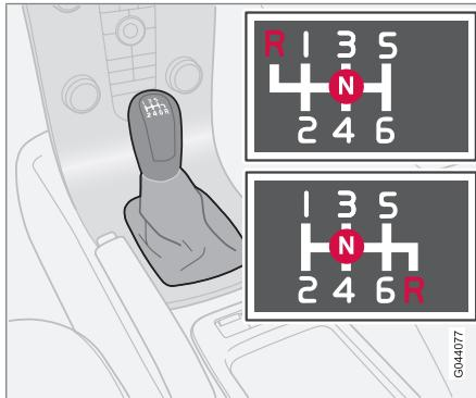
Схема переключения передач, 6-ступенчатая коробка передач
