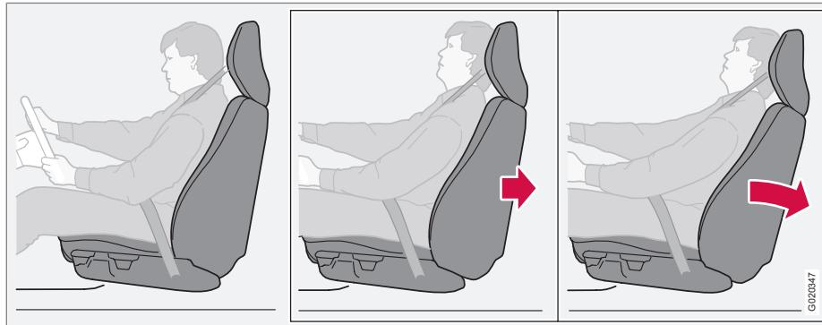
Система WHIPS (Whiplash Protection System) состоит из энергопоглощающей спинки и специально адаптированного к данной системе подголовника в передних сиденьях. Система активируется в момент удара сзади, и ее срабатывание зависит от угла удара, скорости и вида транспортного средства, нанесшего удар.
