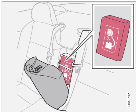
Шиноремонтный комплект используется для герметизации прокола, а также для контроля и регулировки давления в шинах. В него входит компрессор и упаковка с жидким герметиком. Комплект предназначен для временного ремонта. Банка с жидким герметиком должна заменяться до окончания срока действия или после использования.
