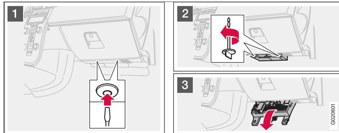
В блоке находятся 50 гнезд предохранителей. Предохранители находятся под отделением для перчаток. Там же предусмотрены гнезда для резервных предохранителей. Инструмент для замены предохранителей находится в блоке реле/предохранителей в двигательном отсеке, см. стр. 253.
