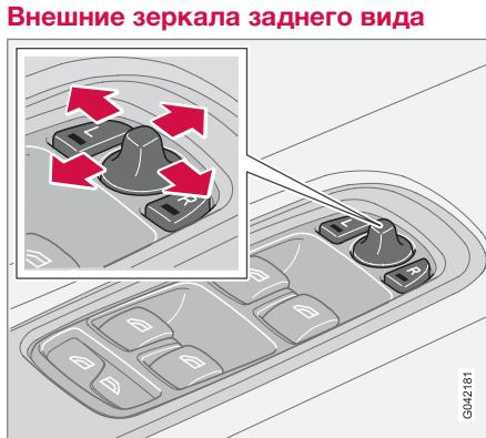
**Складные зеркала заднего вида с электроприводом\***
