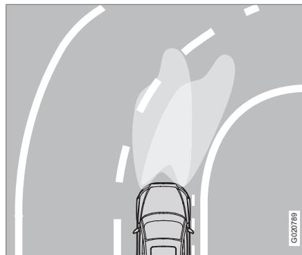
Форма светового пятна с отключенной функцией (слева) и активированной функцией (справа).
