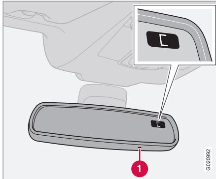
Земной шар разделен на 15 магнитных зон. Компас настроен на тот географический регион, в который осуществлена поставка данного автомобиля. Необходимо провести калибровку компаса, если автомобиль перемещается через несколько магнитных зон.
