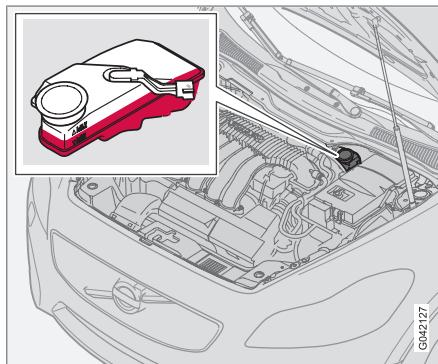
Жидкость тормозов и сцепления заливается в общий бачок<sup>4</sup>. Уровень должен лежать между отметками **MIN** и **MAX**. Регулярно проверяйте уровень. Заменяйте жидкость один раз в два года или при каждом втором плановом техобслуживании.
