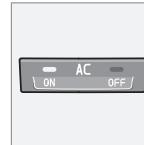
**ON:** Кондиционирование воздуха включено. Регулируется автоматикой системы. В этом случае поступающий воздух охлаждается и подсушивается.
