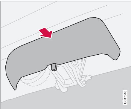
2. Нажмите стопорную ручку и поверните против часовой стрелки до щелчка.
