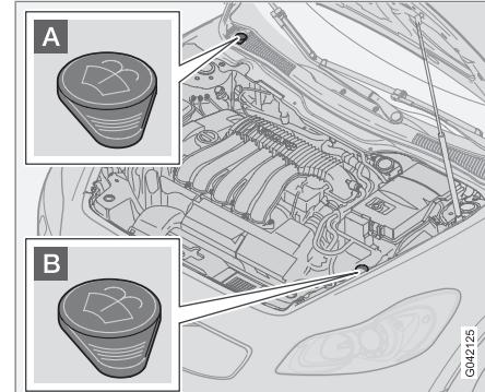
Омыватели ветрового стекла и фар имеют общий бачок с жидкостью.
