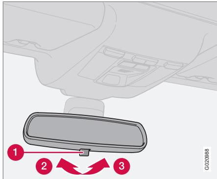
Мощный свет от автомобиля сзади может отражаться в зеркале заднего вида и ослеплять водителя. Если свет сзади раздражает вас, включайте противоослепляющую функцию.
