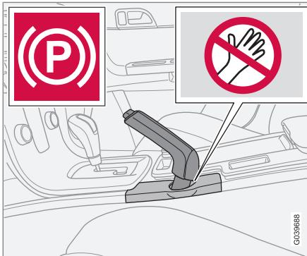
Предупреждающий символ на приборной панели и табличка, предупреждающая об опасности защемления.
