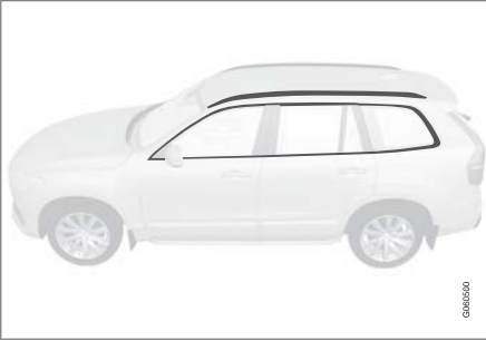
الأجزاء التي ينبغي غسلها باستخدام عنصر تنظيف يحتوي على قيمة pH تتراوح بين ٣,٥ و ١١,٥.
