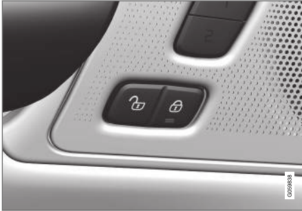
Zamykáací a odemykáací tlačítka s kontrolkou na předních dveřích.
