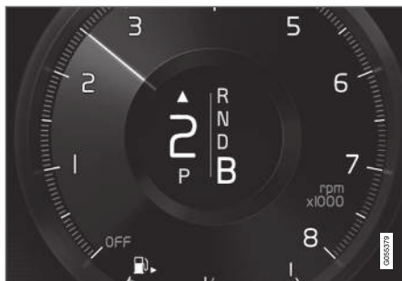
Wskaźnik zmiany biegów na wyświetlaczu kierowcy 3 .
