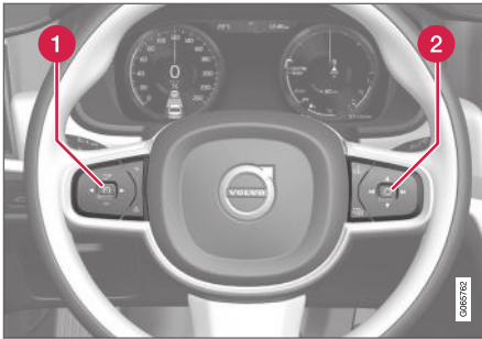
Przyciski sterujące w kierownicy i manetki*.
