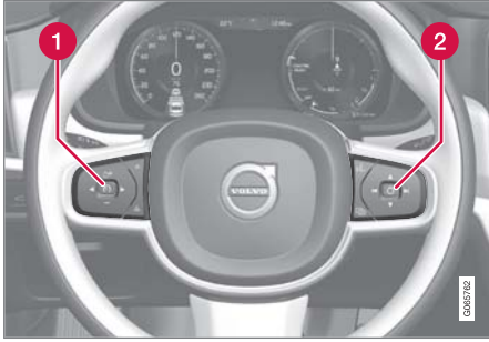
لوحة المفاتيح والموجهات* في عجلة القيادة.
