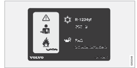
2 ملصق نظام مكيف الهواء في السيارات المزودة بسائل التبريد R.1234yf.
