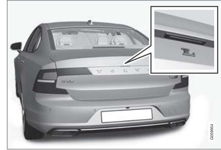
لوح ضغط مكسو بالمطاط على باب صندوق الأمتعة يستخدم لفتح القفل فقط.
