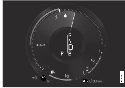
Hem elektrikli motor hem de içten yanmalı motorla tahrik için sürücü gösterge ekranı.
