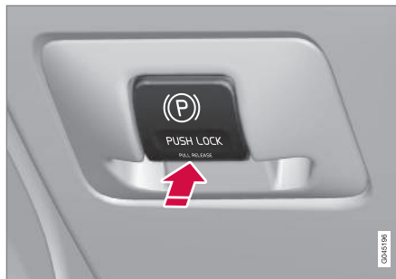
Stāvbremzes vadība - ieslēgšana.
