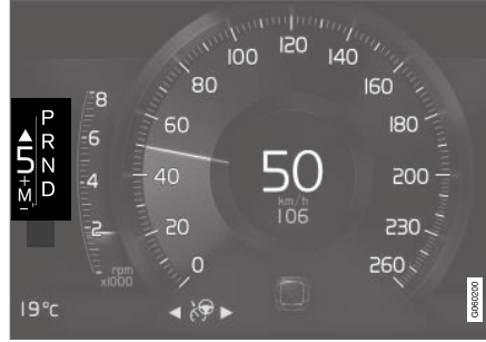
8 inç sürücü gösterge ekranındaki vites değiştirme göstergesi.
