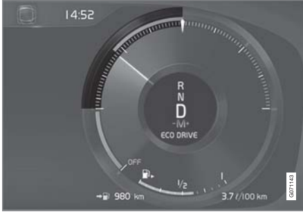
مقياس Eco في شاشة السائق قياس ١٢ بوصة*.
