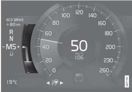
مقياس Eco في شاشة السائق قياس ٨ بوصة.
