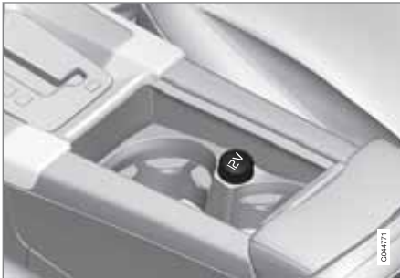
12 V-uttag i tunnelkonsol, framsäte.
