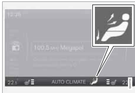
Vald luftfördelning visas i mittkonsolens bildskärm.
