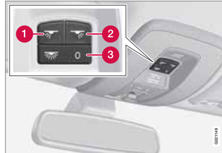
Reglage i takkonsolen för främre läslampor och kupébelysning.
