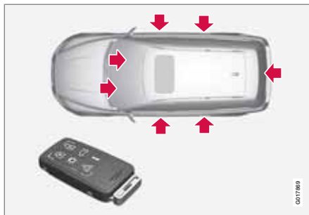
Låspunkter för fjärrnyckel med nyckelblad.
