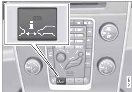
Reglage och display för tidsavstånd.
