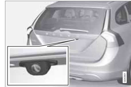
Kamerans placering intill öppningshandtaget.
