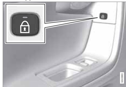
Knappens lampa lyser när dörren är låst.
