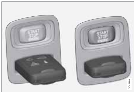
Startlås med fjärrnyckel utdragen/intryckt.
