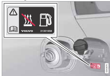
Varningsdekal på tankluckan.
