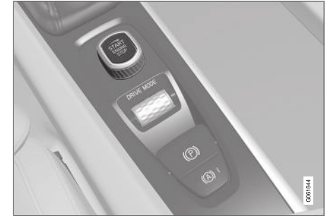
Indító gomb az alagútvezérlőn.
