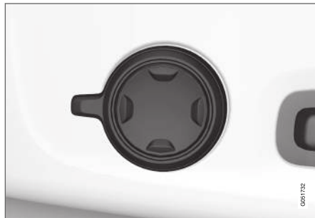
Többfunkciós kezelőszerv, az ülés ülőrészének oldalán.
