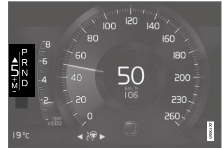
Fokozatváltás-jelző a 8-hüvelykes járművezetői kijelzőn.
