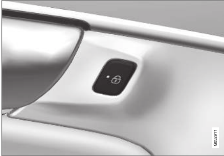
Záró gombok visszajelző lámpával a hátsó ajtóban.
