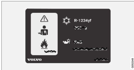
2 Kondicionieriaus lipdukas automobilyje, kuriame naudojamas R1234yf šaldymo skystis.
