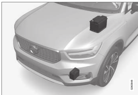
Pagalbinis akumulatorius įrengtas variklio skyriaus apačioje. Ten taip pat yra starterio akumulatorius (viršuje).
