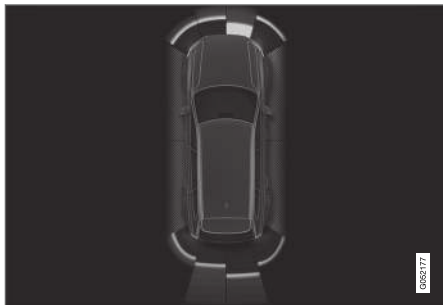
Bildskärmsvy med hinderzoner och sensorsektorer.
