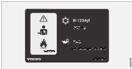
2 Dekal A/C-systemet för bilar med köldmediet R1234yf.
