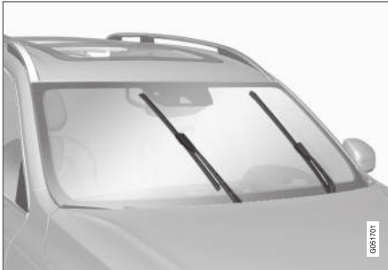
Torkarblad i serviceläge.
