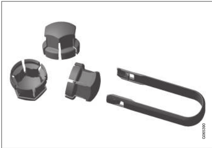
Verktyg för borttagning av plasthattar på hjulskruvarna.
