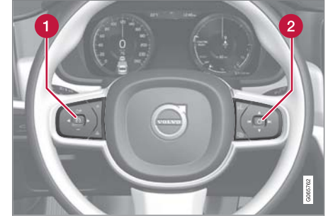
لوحة المفاتيح والموجهات* في عجلة القيادة.
