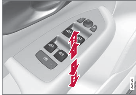
تشغيل النوافذ الكهربائية.
