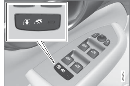
زر التنشيط وإلغاء التنشيط الكهربائي.
