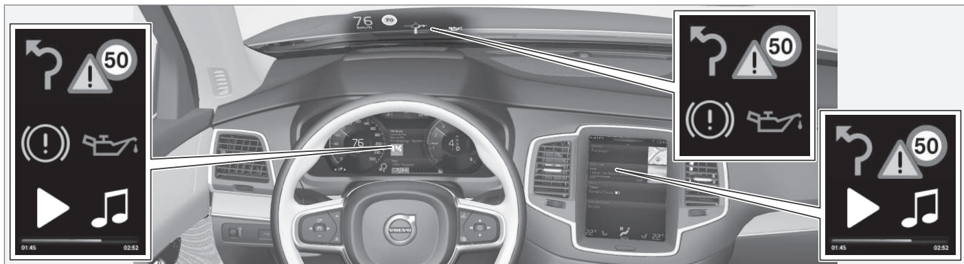
Olika typ av information visas i olika displayer beroende på hur informationen bör prioriteras.
