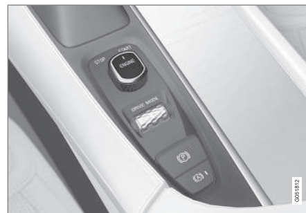
Startvredet i tunnelkonsolen.
