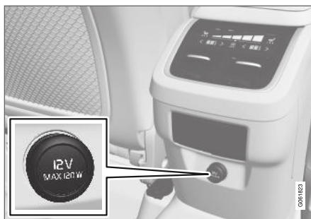
12 voltos elektromos aljzat az alagút-konzolban, hátsó ülés.
