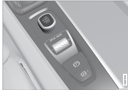
Startvredet i tunnelkonsolen.
