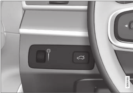
Forgókapcsoló (balra) a belső fényerő beállításához.
