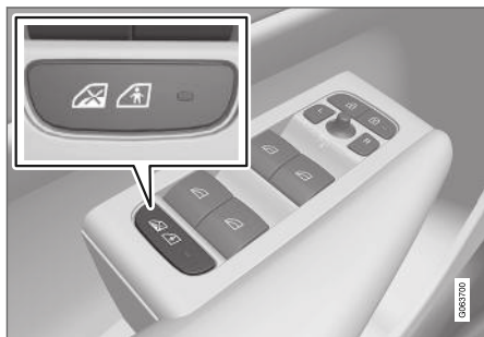
Gomb az elektromos aktiváláshoz és inaktíváláshoz.
