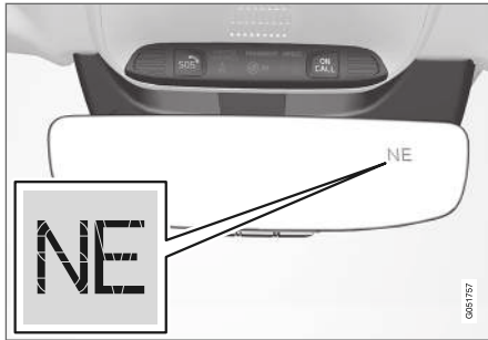
Visszapillantó tükör iránytűvel.
