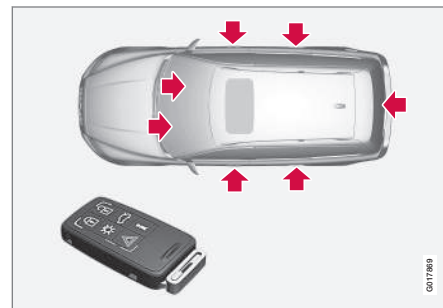
Aktīvie slēdži tālvadības pults atslēgai ar atslēgas slēdzošo daļu.
