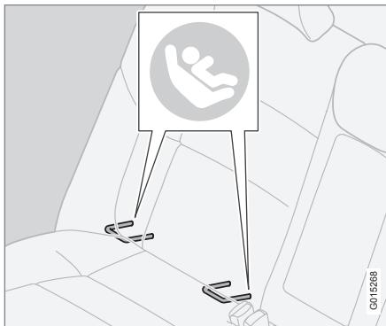
Точки крепления системы ISOFIX спрятаны сзади в нижней части спинки внешних мест заднего сидения.
