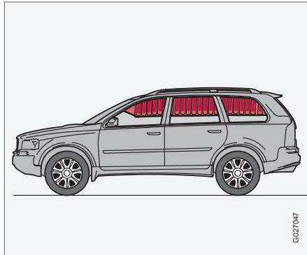
Надувной занавес IC (Inflatable Curtain) является элементом системы SIPS и подушек безопасности. Он смонтирован в облицовке потолка вдоль боковин автомобиля и защищает пассажиров на внешних местах в автомобиле. При достаточно сильном столкновении датчики реагируют, и занавес надувается. Надувной занавес помогает во время столкновения защитить голову водителя и пассажиров от ударов о внутренние поверхности автомобиля.
