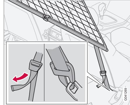
Если на автомобиле установлена защитная шторка, снимите ее перед установкой защитной сетки.
