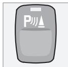
При запуске двигателя система всегда активирована. Нажмите кнопку для отключения/подключения системы, предупреждающей о движении задним ходом.
