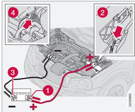
Пусковой аккумулятор установлен в задней части автомобиля (см. стр. 235), но точки подсоединения имеются также и под капотом.
