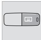
Обогрев используется для удаления обледенения и запотевания с заднего стекла и зеркал заднего вида. При нажатии на выключатель запускается обогрев заднего стекла и зеркал заднего вида. Лампа в выключателе светится. Обогрев автоматически отключается прим. через 12 минут.
