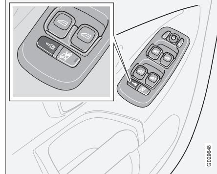
Автоматическое запирание активируется и отключается с кнопочной панели на двери водителя. Функция означает, что двери запираются автоматически на скорости автомобиля выше 7 км/ч. Двери остаются запертыми до тех пор, пока какая-либо дверь не открывается изнутри, или если все двери отпираются с панели управления.
