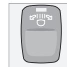
Если в автомобиле установлены активные ксеноновые фары (Active Bending Lights,ABL), во время движения свет от фар следует за движением рулевого колеса.
