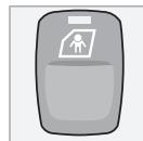
Используется для активирования или отключения блокировки замков для безопасности детей в задних дверях. Дистанционный ключ должен находиться в положении I или II. Лампа в кнопке горит, когда блокировка для безопасности детей активирована. Когда вы активируете или отключаете блокировку для безопасности детей, на дисплее показывается сообщение, см. стр. 141.
