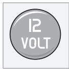
Электрическое гнездо можно использовать для подключения различного дополнительного оборудования на 12 В, например, мобильного телефона или холодильника.
