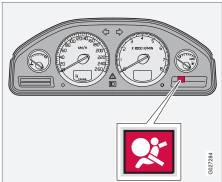
Предупреждающий символ в комбинированном приборе включается при повороте дистанционного ключа в положение I, II или III. Символ гаснет прим. через 6 секунд, если система подушек безопасности исправна.
