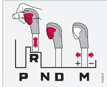
Вы можете всегда перемещать рычаг селектора передач свободно вперед или назад между положениями **N** и **D**. На других положениях передач установлен блокиратор, который управляет кнопкой блокировки на рычаге селектора передач.
