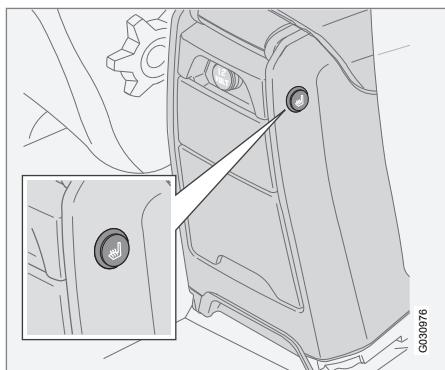
Кнопка для включения/отключения обогрева задних сидений.
