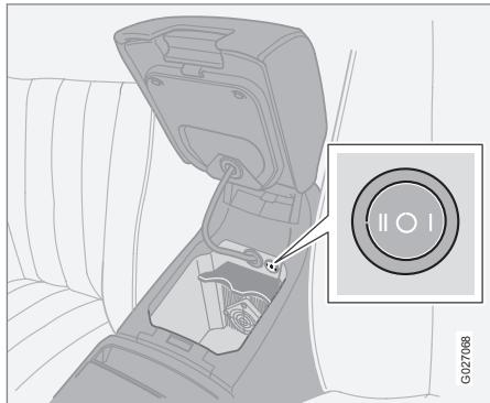
Под откидывающимся подлокотником переднего сидения находится холодильник. Уровень охлаждения регулируется кнопкой (см. рисунок). Холодильник действует, когда двигатель работает или ключ находится в положении II.
