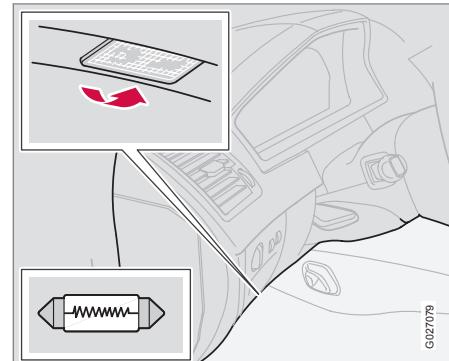
Освещение порогов расположено под приборной панелью на стороне водителя и пассажира.
