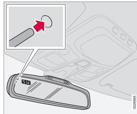
В верхнем левом углу зеркала заднего вида установлен дисплей, который показывает, в каком направлении по компасу направлена передняя часть автомобиля. Восемь различных направлений обозначаются сокращениями на английском языке: **N** (север), **NE** (северо-восток), **E** (восток), **SE** (юго-восток), **S** (юг), **SW** (юго-запад), **W** (запад) и **NW** (северо-запад).
