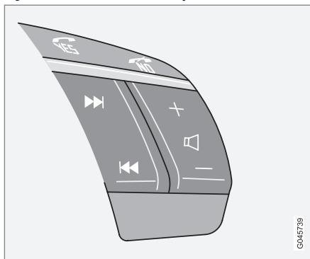
Четыре нижние клавиши клавиатуры на руле общие для радио и для телефона. Функция кнопки зависит от того, какая система активирована. При помощи клавиатуры на руле вы можете регулировать звук, переключаться между запрограммированными станциями и менять дорожку на компакт-диске. Две верхние кнопки на кно-
