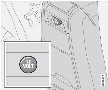
Электрическое гнездо можно использовать для различного дополнительного оборудования, например, мобильного телефона или холодильника. Оно рассчитано на 12 В. Дистанционный ключ должен находиться, как минимум в положении I, чтобы на гнездо подавалось питание.
