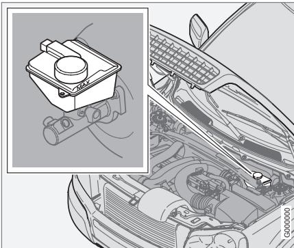
Жидкость тормозов и сцепления заливается в общий бачок<sup>1</sup>. Уровень должен лежать между отметками **MIN** и **MAX**. Регулярно проверяйте уровень. Заменяйте жидкость один раз в два года или при
