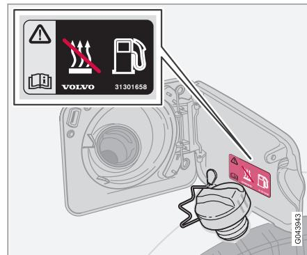
Предупреждающая табличка на крышки топливного бака.
