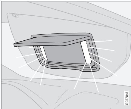
Лампа включается автоматически при подъеме крышки.
