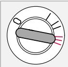
Активируется стартер. После пуска двигателя дистанционный ключ отпускается и автоматически отпружинивает назад в положение движения.
