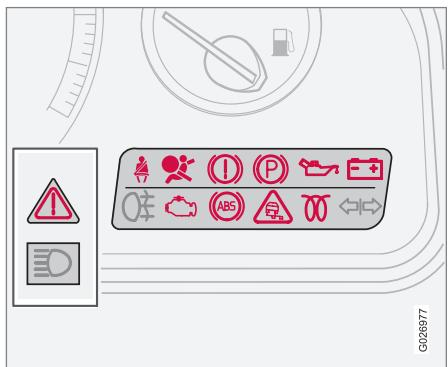
Перед пуском двигателя все контрольные и предупреждающие символы<sup>1</sup> включаются после поворота дистанционного ключа в положение II. Так проверяется функционирование символов. После запуска двигателя все символы должны погаснуть, за исключением стоячного тормоза, который гаснет после отпускания тормоза.
