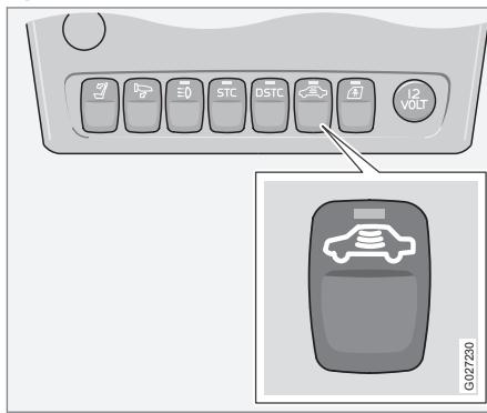
Кнопка для временного отключения блокировки замков.
