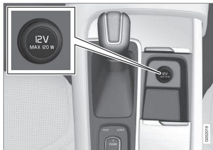
12 V elektrības kontaktlīgšana tuneļkonsolē, pie priekšējiem sēdekļiem.
