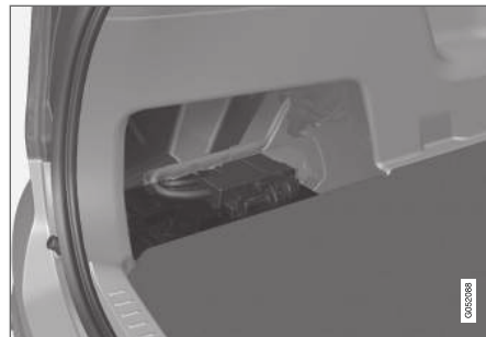
Spouštěcí baterie se nachází v zavazadlovém prostoru.
