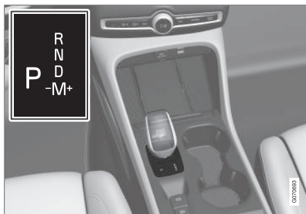
Vue d'ensemble du petit levier de vitesses avec grille de positions sur l'écran conducteur
