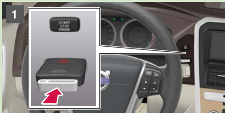
1. Transpondersleutel in het contactslot plaatsen en tot aan de aanslag naar binnen duwen.
