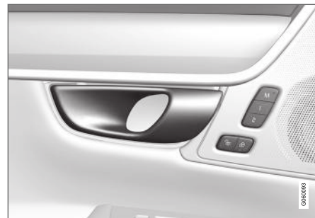
Poignée d'ouverture pour le déverrouillage alternatif d'une porte latérale 16 .
