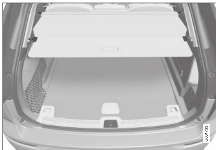
Cache-bagages en position de couverture intégrale.
